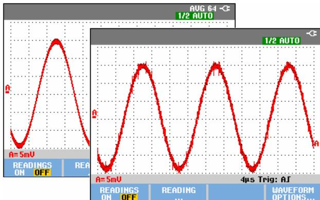
Рис. 9. Сглаживание осциллограммы
