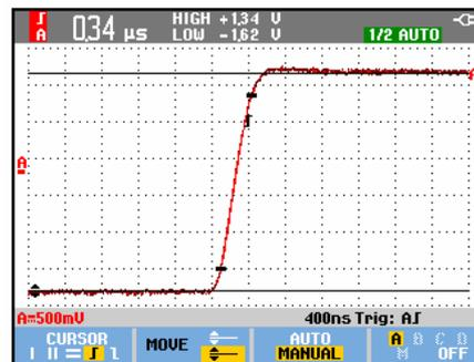
Рис. 27. Измерение времени нарастания
