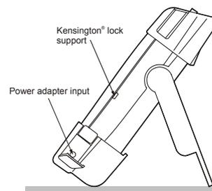
**Рис. 44. Использование наклонной подставки**
