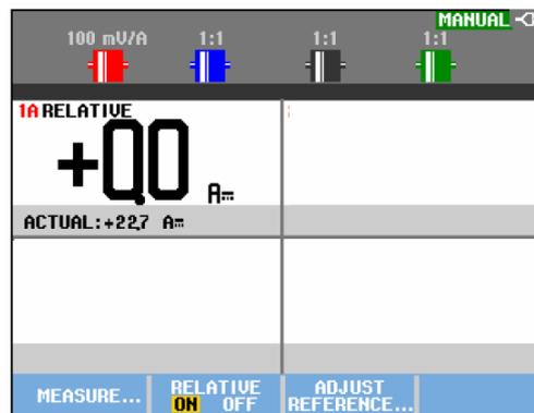
Рис. 13. Проведение относительного измерения
