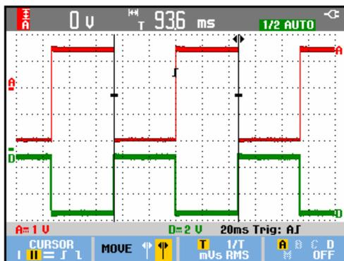
Рис. 26. Измерение временных интервалов с помощью курсоров
