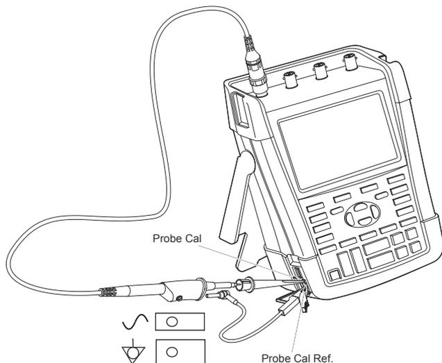
**Рис. 50. Регулировка датчиков напряжения**
