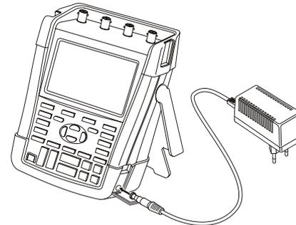
**Рис. 46. Зарядка аккумуляторов**
