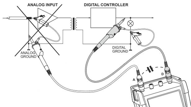
**Рис. 43. Неправильное подключение проводов для опорных потенциалов**
