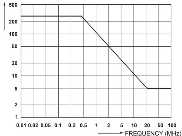
**Рис. 51. Макс. входное напряжение в зависимости от частоты**
