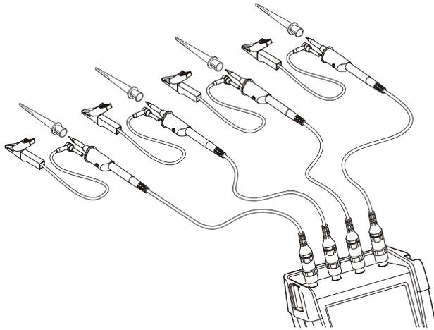
**Рис. 38. Подключение электронных измерительных устройств для проведения измерений в режиме измерителя (используются зажимы типа "крючок", а для заземления - зажим типа "крокодил")**
