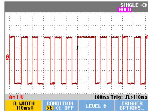
Рис. 34. Запуск развертки по пропуску импульсов
