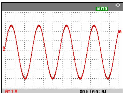
Рис. 7. Вид экрана после автоматической настройки параметров изображения
