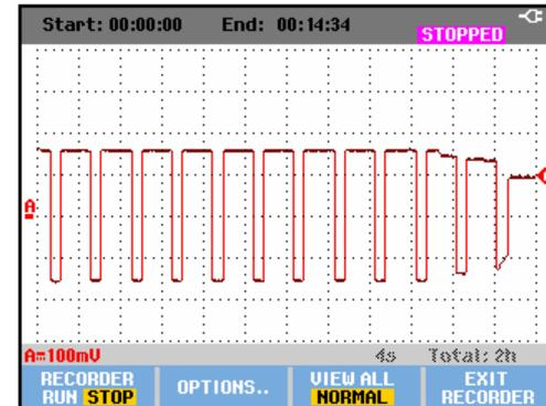
Рис. 22. Запись в режиме однократной развертки с остановкой по внешнему сигналу
