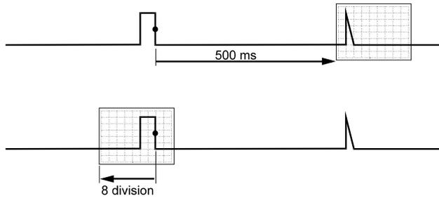
Рис. 29 На рисунке показаны примеры запуска развертки с задержкой на 500 миллисекунд (вверху) и с опережением на 8 делений (внизу).
