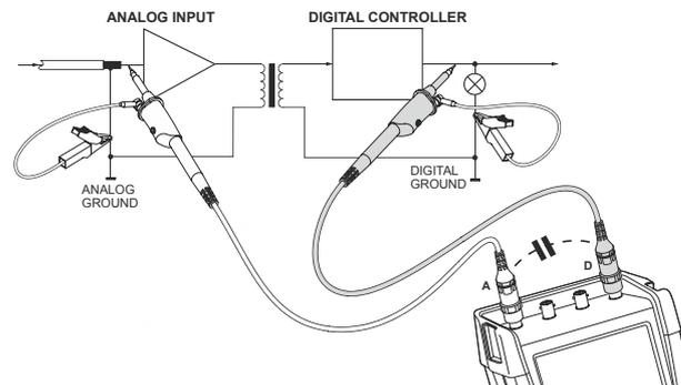
Рис. 42. Правильное подключение проводов для опорных потенциалов
