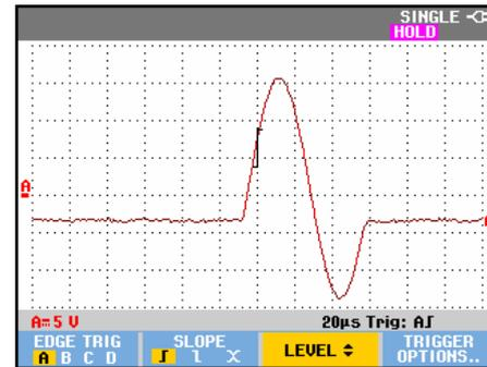
Рис. 30. Измерение в режиме однократной регистрации
