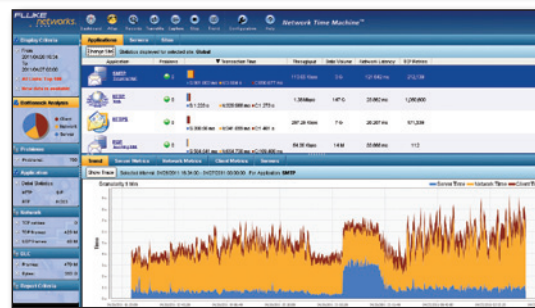
Рис. 1. Функция анализа "узких мест" на NTM V8.0 показывает среднее время задержки приложения (например, SMTP и HTTP) на сервере и в сети. На нижней диаграмме отображается резкое увеличение времени отклика сервера и возврат к норме за анализируемый период времени.
