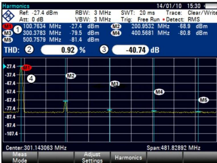
Рисунок 8.8 – Вид экрана при измерении коэффициента нелинейных искажений
