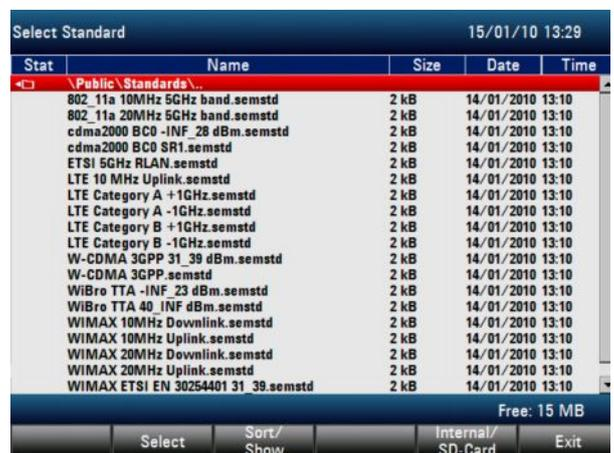
Произойдет установка выбранного стандарта. Оптимальная полоса обзора, полоса разрешения, полоса видеофильтра, время развертки и детектор для установленного стандарта выбираются автоматически.
