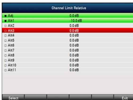
Для деактивации проверки предела для отдельного канала необходимо с помощью поворотной ручки или клавиш курсора переместить курсор на нужный канал и отменить выбор нажатием функциональной клавиши SELECT.
