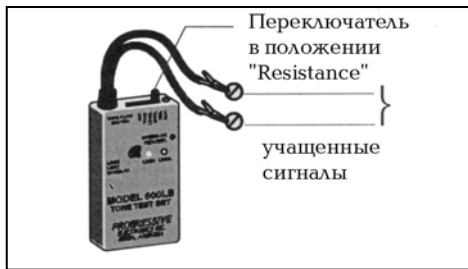
Рис. 5. Проверка целостности линии.
