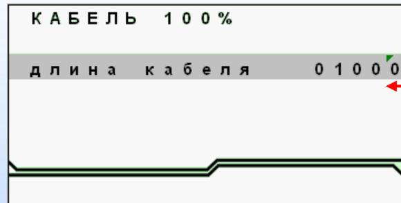
При включении Кабель 100% уже находится в «кармане» прибора. Если нажать на кнопку «карман», можно ввести длину кабеля. Если ничего не делать, расстояние до повреждения будет выводиться в % длины кабеля.
