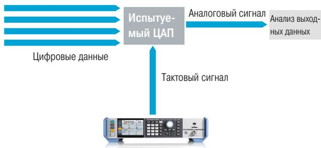
Типичная установка для проверки параметров ЦАП.
