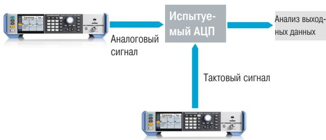
Установка для измерения параметров АЦП, состоящая из двух генераторов R&S®SMA100B, которые используются в качестве источников аналогового и тактового входных сигналов.
