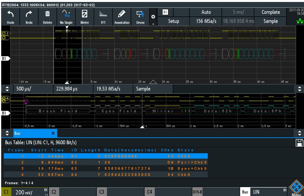
Рис. 12-33: Декодированный сигнал LIN с таблицей для кадра и включенным списком меток
