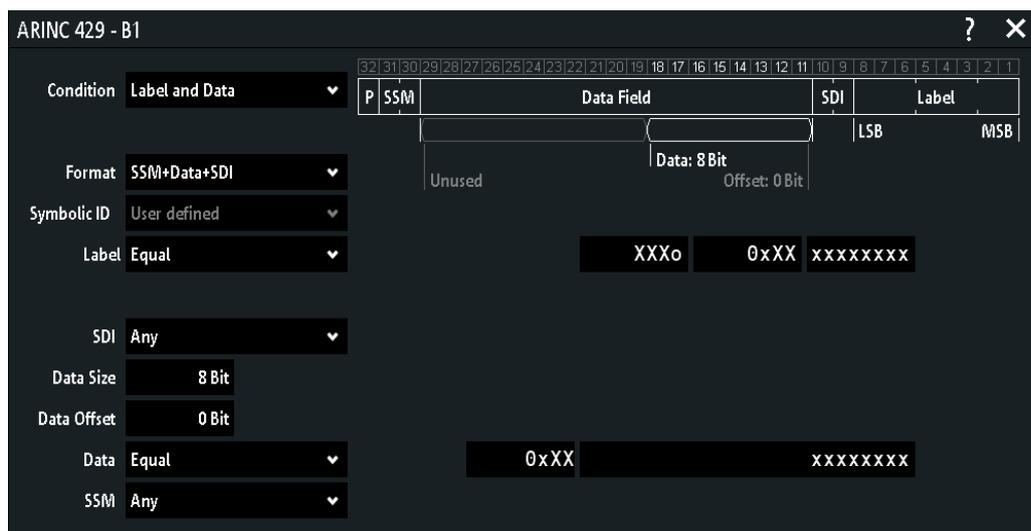
Рис. 12-43: Настройки поиска по сигналам шины ARINC 429
