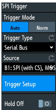
Рис. 12-5: Меню запуска по сигналам шины SPI
