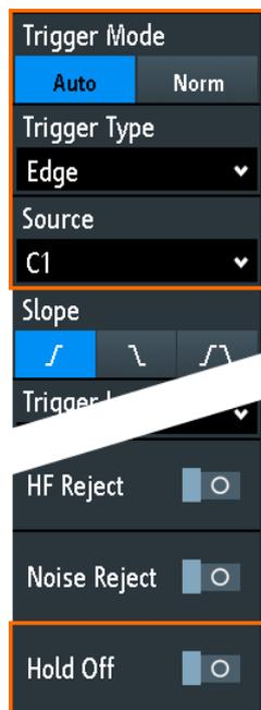
Общие настройки запуска не зависят от установленного типа запуска. Они выделены на приведенном выше рисунке и описаны в текущем разделе. Другие параметры запуска являются специфическими для конкретных типов запуска, они описаны в следующих разделах.
