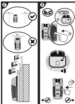
**Remarque:** L'unité ne doit pas être déplacée avant d'en avoir fini l'étalonnage.
