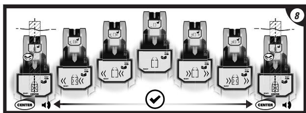
⑥ / ⑦ Quand elle détecte le centre du montant, l'icône « Center » (Centre) apparaîtra sur l'affichage à LCD (cristaux). Utilisez le canal de marquage au haut de l'unité pour marquer le centre du montant sur le mur.
