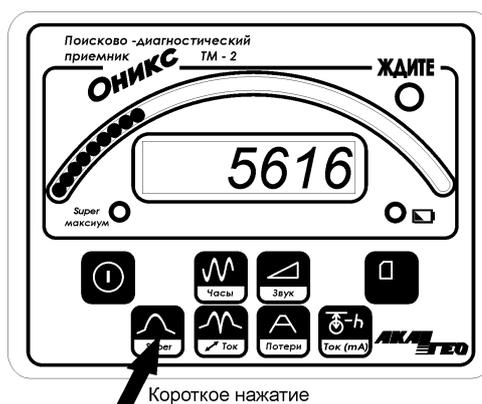
Рис 3.3.. Отображение информации в режиме «минимума»
