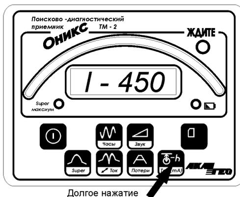
Рис 3.5.1. Отображение информации в режиме измерения тока
