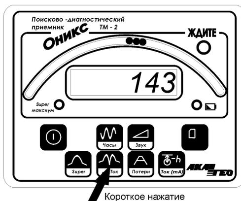
Рис 3.4.1. Отображение информации в режиме «минимума»
