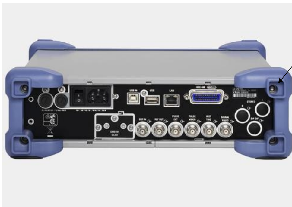
Рисунок 2 - Схема пломбировки от несанкционированного доступа
