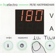
**Установка верхнего предела ( заводская установка 250В) и максимального тока (защита от перегрузки):** Нажатием кнопки **TUb/Aм** на экран выводится значение верхнего предела напряжения и максимального тока. При удержании более 3 секунд прибор перейдет в режим установки верхнего предела (будет мигать точка в правом углу индикатора **V**). Кнопками (-) или (+) установите нужное значение (230-270 Вольт).
