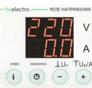
Если напряжение в сети не выходит за установленные пределы (180-250В по умолчанию), через 5 секунд прибор подключит нагрузку к сети, индикаторы перестанут мигать, индикатор **A** покажет действующий ток нагрузки. В дальнейшем при любом повышении или понижении уровня напряжения сети устройство отключит нагрузку, индикатор **V** в мигающем режиме будет отображать уровень напряжения в сети. Нагрузка не будет подключена до тех пор, пока напряжение не нормализуется.
