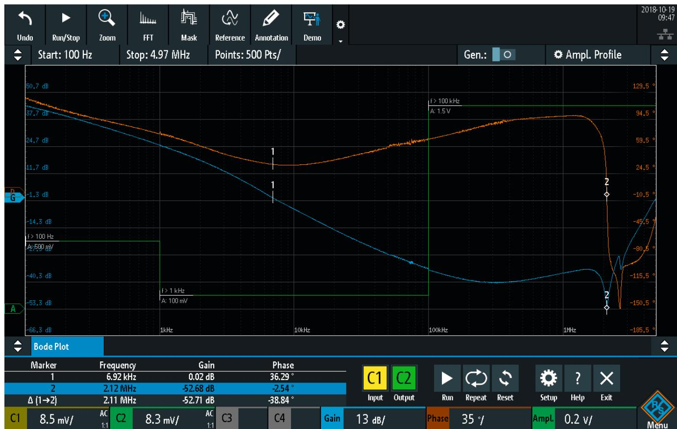
Опция анализа частотных характеристик (ЛАФЧХ или диаграмм Боде) позволяет определять АЧХ множества электронных устройств, включая пассивные фильтры и контуры усиления
