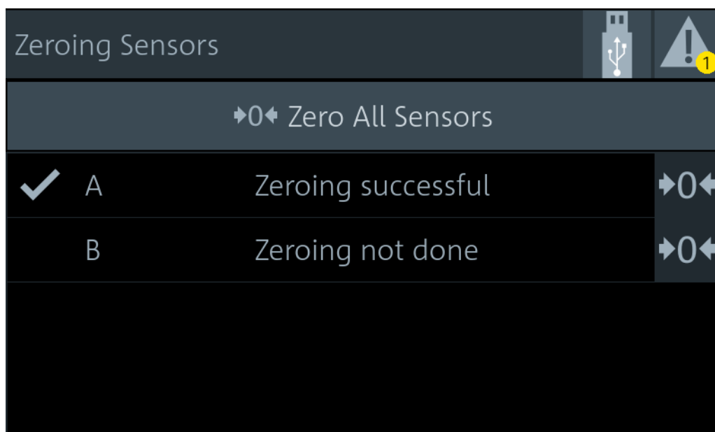
Рисунок 10-1 – Диалоговое окно Zeroing Sensors (установка нуля датчиков)
