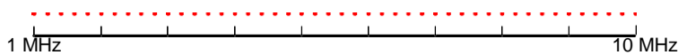
Рис. 8-39: Линейный масштаб по оси X: расстояние между точками развертка одинаково, например 200 кГц
