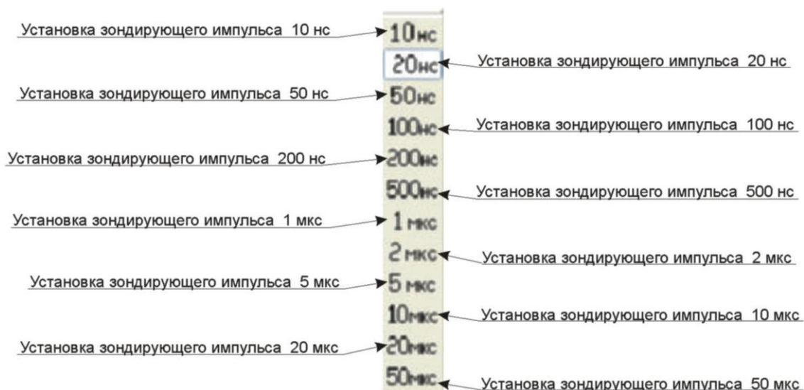
Рисунок 6-3. Установка длительности зондирующего импульса
